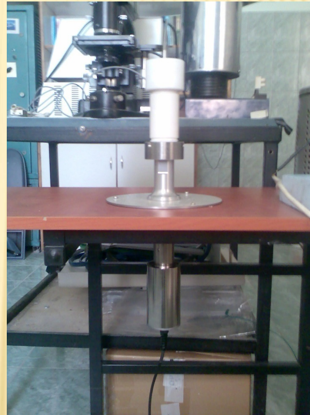
Instalatie de sinteză a materialelor nanocristaline prin metoda hidrotermală asistată ultraacustică combinată cu încălzirea în câmp de microunde (OSIM Nr. A/01020/24.12.2008)
