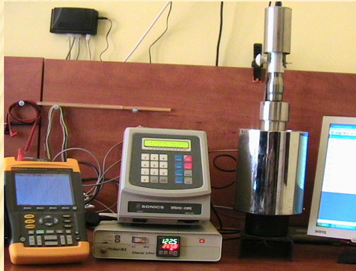
Instalatie experimentală de obținere a nanoparticulelor prin metoda hidrotermală asistată ultrasonică cu sonotrodă imersată (OSIM Nr. A/01019/24.12.2008)
