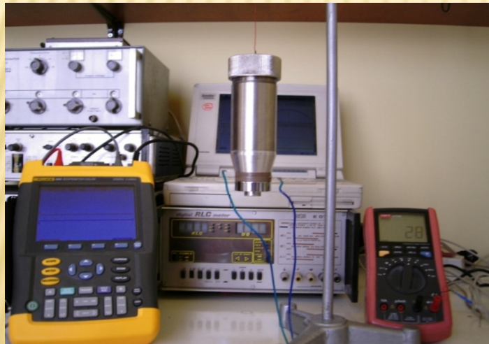
Instalatie experimentală de obținere a nanoparticulelor prin metoda hidrotermală asistată ultrasonică fără sonotrodă imersată
